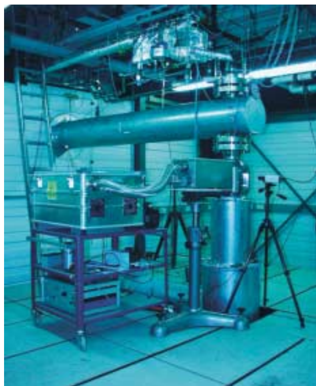
Figure 1. Photographie d'ensemble du dispositif sur l'installation M51 du DLR de Lampoldshausen. On peut y voir le flash X devant la boucle de gaz et la chambre haute pression contenant l'injecteur.
