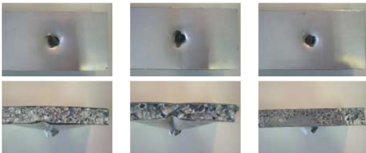
Figure 2. Comportement à la perforation de structures sandwich simples constituées de mousses en aluminium présentant des masses volumiques différentes (croissantes de gauche à droite). Les peaux sont en alliage d'aluminium 2024. Photos de Luc Salvo, GPM2, INP Grenoble.
