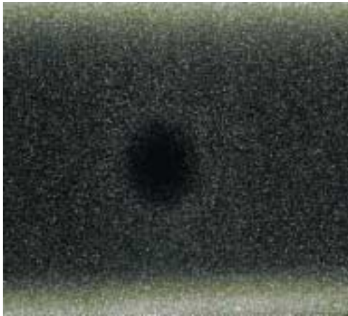
Figure 2. a) Image de PIV d'un tourbillon marginal enregistrée au DLR dans la soufflerie DNW-LLF dans le sillage d'un avion de transport en configuration d'atterrissage. Le plan laser est à 1,64 m derrière l'aile. L'écoulement principal traverse le plan de l'image. La taille du champ visualisé est de 170 x 140 mm 2 . Cette image fait partie des cas test du Challenge 2001. b) champ de vitesse déduit de l'image a).
