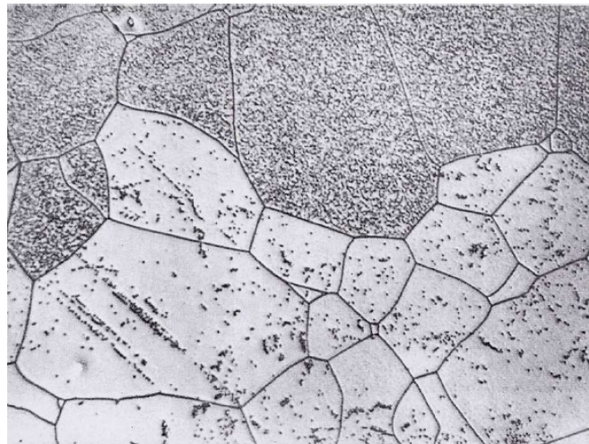
FIG. 2.8 – Attaque au voisinage d'un front de bandes de Lüders sur un acier non calmé partiellement décarburé, par trempe à 620°C et déformé en traction à température ambiante et vieilli à 100°C [Wilson, 1968]. Sites des dislocations en présence d'un front de bande de Lüders, grains déformés par la bande de Lüders (en grisé).
