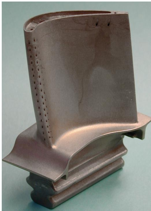
Figure 1: Aube de turbine monocristalline multiperforée (source SNECMA). La hauteur de la pièce est de 12 cm. Les trous sont destinés à laisser circuler un flux d'air froid pour refroidir l'aube qui reçoit le flux des gaz de combustion.
