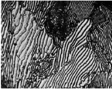
microstructure lamellaire d'un acier perlitique
