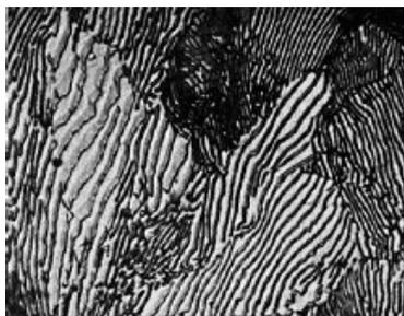
microstructure lamellaire d'un acier perlitique
