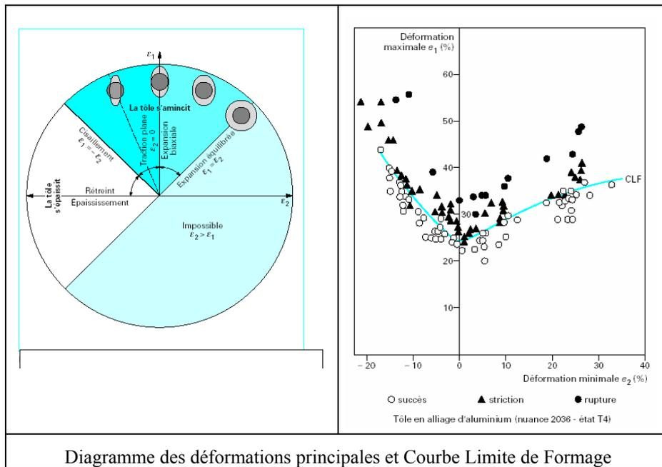
Diagramme des déformations principales et Courbe Limite de Formage
